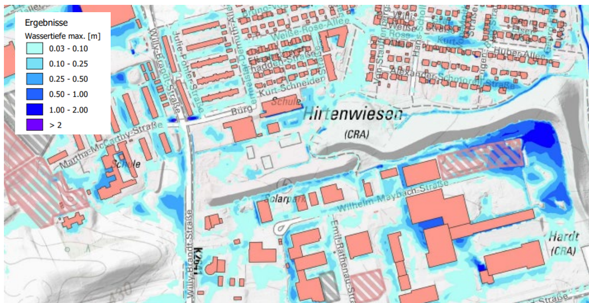
Abbildung 07: Ausschnitt der Starkregenereigniskarte Lastfall „außergewöhnlich, verschlämmt“ mit maximalen Wassertiefen
